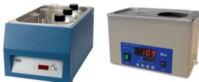
Un baño refrigerante es una mezcla usada en un laboratorio cuando se necesitan temperaturas bajas (reacciones químicas a baja temperatura, recuperación de los condensados muy volátiles, trampas frías,...).
