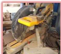
Sierra eléctrica con disco de corte circular. Puede estar en una bancada, en un soporte móvil de inclinación regulable o en una máquina
