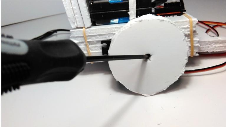
Figura 1.1.4-16 Fijación de las ruedas a los servos
