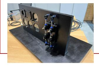
Diseño y fabricación de un sistema automático de gestión de presiones barométricas en un demostrador de panel de instrumentos de vuelo en un avión ligero
